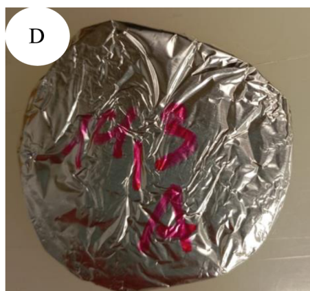
Obrázek 4. 3. 5. I: A-vytvoření alobalové misky s přesahy, B-vysušený odparek v podobě v jaké je vkládán do sušárny, C-stlačení přesahů misky k zaizolování odparku, D-označení vzorku na spodní straně, lepší čitelnost a ochrana před poškozením při manipulaci
