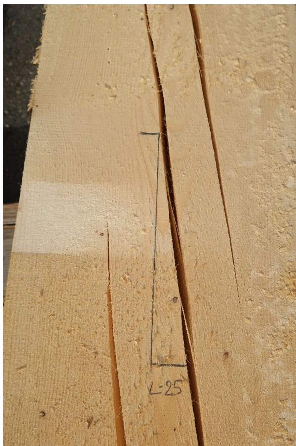
Obrázek 4.15 – měření odklonu vláken ze vztahu výsušné trhliny a čáry označující osu trámu
