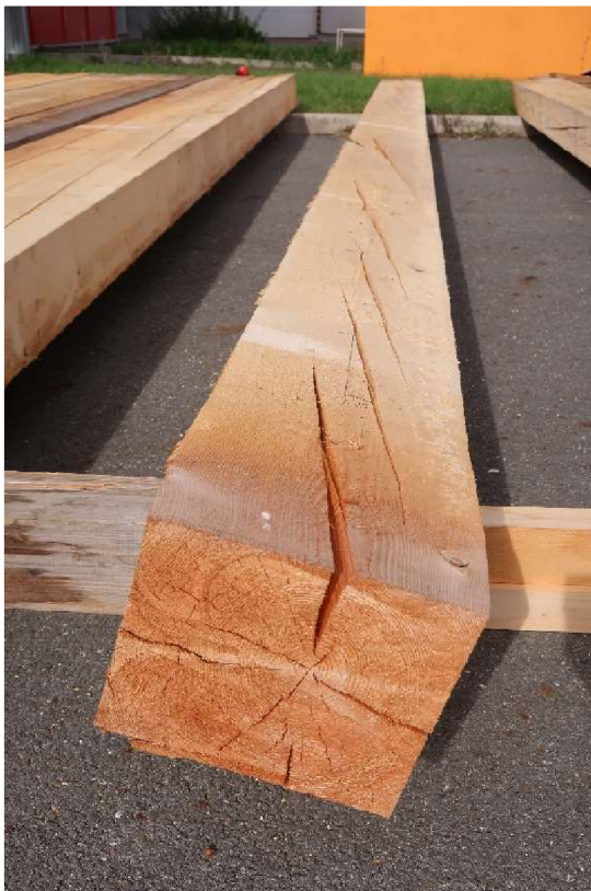
Obrázek 5.1 – extrémně levotočivý trám 21–S
