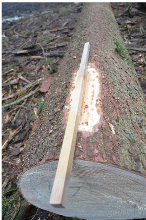
Obrázek 4.10 – lať pro značení osy kulatiny s vyznačeným délkovým úsekem 200 mm
