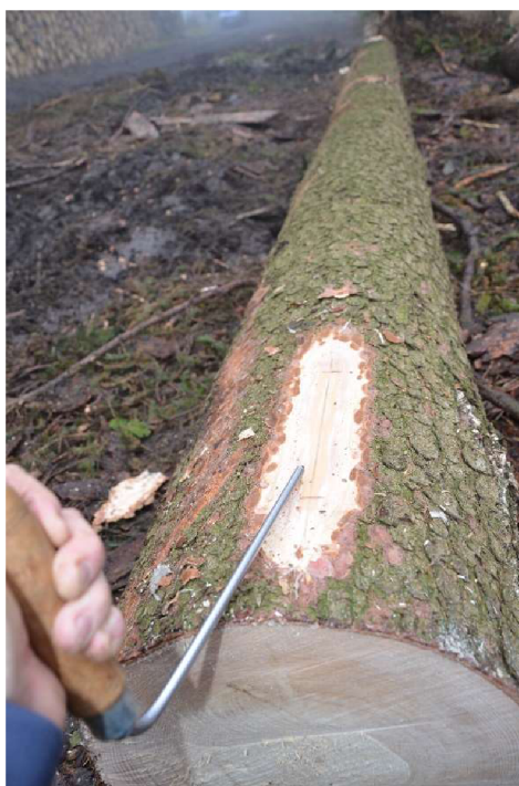
Obrázek 4.12 – tah črtákem ke spodní pomocné čáře
