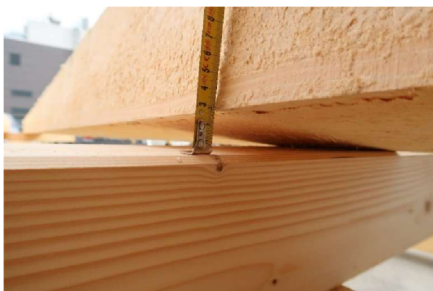
Obrázek 4.16 – měření kroucení trámů svinovacím metrem
