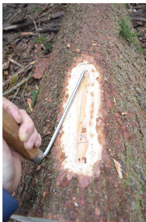
Obrázek 4.11 – počáteční stav při měření točitosti na kulatině pomocí črtáku (zaražení hrotu črtáku do výchozího místa v ose kulatiny)
