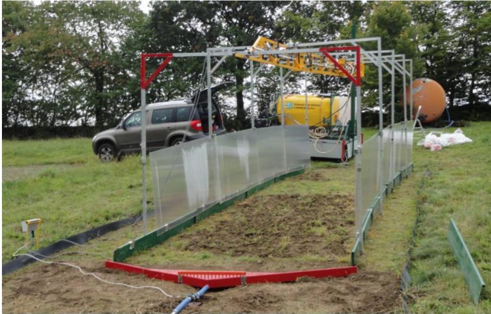
Obrázek 9 – Polní simulátor deště výzkumného ústavu meliorací a ochrany půdy; Zdroj: ( https://www.vumop.cz/simulator-deste )
