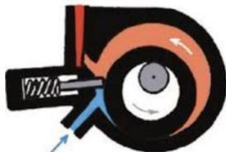
Obrázek 1.3: Rotační kompresor s válcovým pístem [13]
