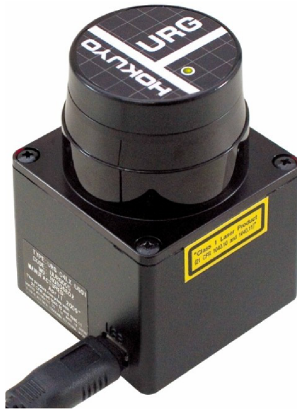
Obr. 2.23: Laserový skener Hokuyo URG-04LX-UG01
