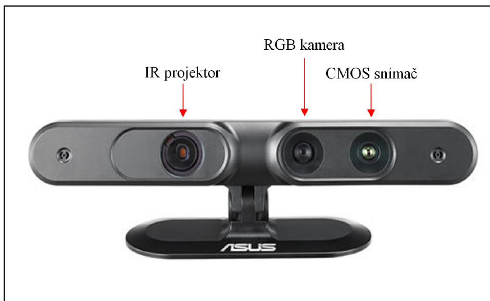
Obr. 2.21: Snímač Asus Xtion PRO LIVE [23]
