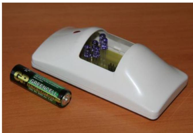
Obr. 2.1: Příklad majáku pracujícího jako infračervený vysílač [5]
