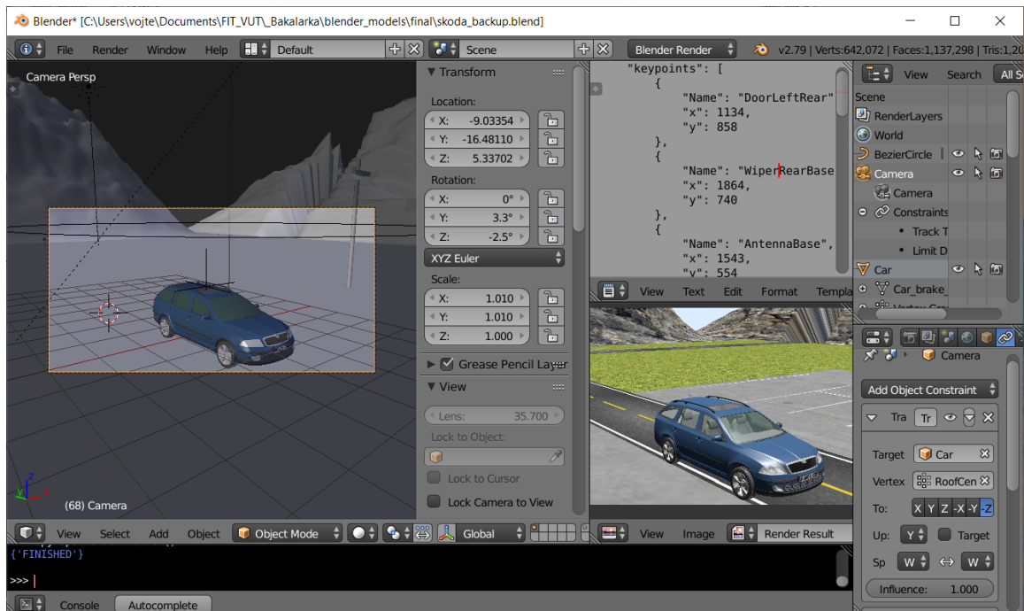
Obrázek 2.7: Prostředí programu Blender 2.79. V levé části okna se nachází 3D pohled na objekt (model automobilu a scény na pozadí), v pravé spodní části vyrenderovaný snímek, v pravé horní části vygenerovaný soubor s anotacemi jednotlivých význačných bodů a nejvíce vpravo potom okna umožňující nastavování vlastností jednotlivých objektů scény. Ve spodní části okna je dále konzole pro skriptování v jazyce Python.
