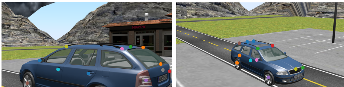
Obrázek 3.1: Při generování trénovacích dat jsou renderovány snímky automobilu z různých úhlů pohledu. Barevné tečky na obrázcích zde reprezentují polohu několika vybraných význačných bodů (jejich souřadnice jsou uloženy v souboru s anotacemi).
