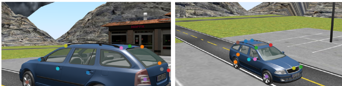
Obrázek 3.1: Při generování trénovacích dat jsou renderovány snímky automobilu z různých úhlů pohledu. Barevné tečky na obrázcích zde reprezentují polohu několika vybraných význačných bodů (jejich souřadnice jsou uloženy v souboru s anotacemi).
