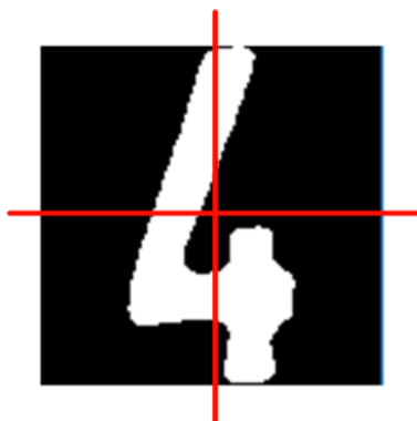
Obrázek 4.11: Znázorněné rozdělení čtverce na čtvrtiny, pro které je poté vytvořena vertikální a horizontální projekce.
