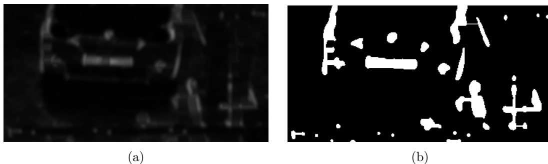
Obrázek 4.6: Obrázek (a) ukazuje zvýraznění celé registrační značky. Na obrázku (b) je výsledek prahování metodou Otsu.
