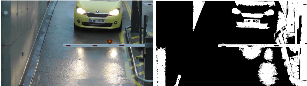
Obrázek 3.2: Na obrázku vlevo je zobrazen vstup algoritmu MSER. Na obrázku vpravo jsou bíle vykresleny extrahované maximálně stabilní extrémní regiony.
