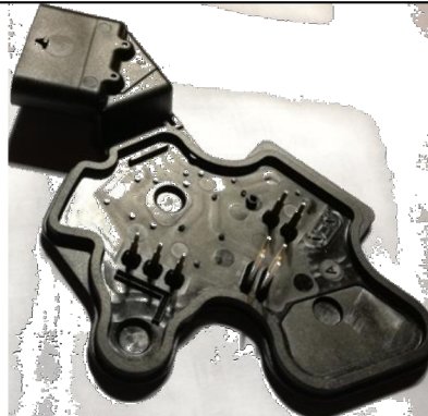
Obr. 42 Reálný kus hlavního vstříku
