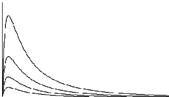
Obr. 6 Závislosť výstupného napätia v čase na rôznych koncentráciách alkoholu (prevzaté z [5])
