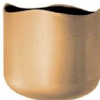
Obr. 34 Kalíšok vyrobený hlbokým ťahaním [28]
