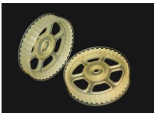
Obr. č. 3 Model soukolí vytištěného prostřednictvím tiskárny Solido SD300 [8]
