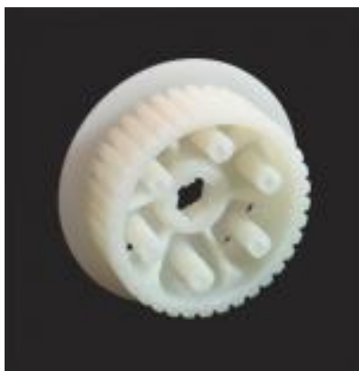
Obr. č. 4 Model soukolí vytištěného prostřednictvím tiskárny Solido SD300 [8]
