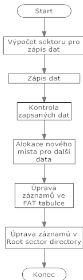
Obr. 19: Zápis dat na flash kartu
