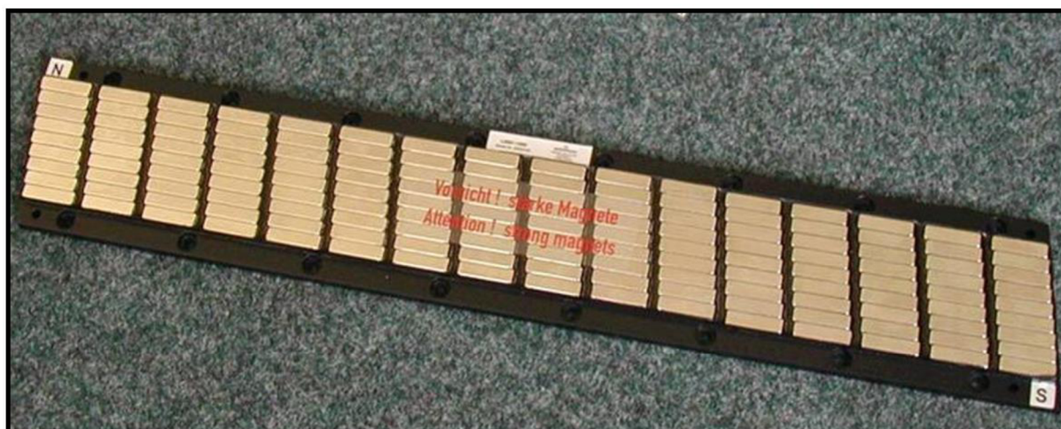
Obrázek 2-2 Šikmo lepené magnety na sekundární části, převzato z [28]
