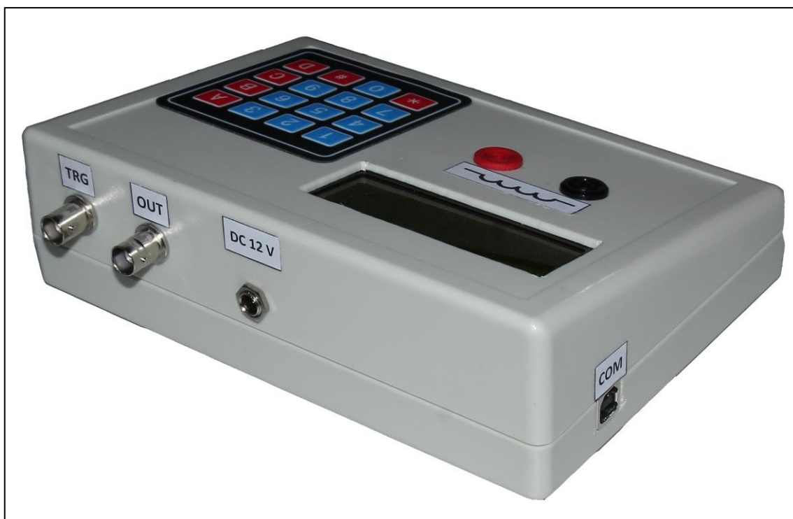
Obrázek 36: Kryt zařízení s nalepenými popisky nad konektory. TRG je externí spoušť osciloskopu, OUT je výstupní napětí z měřicího děliče, DC 12 V je napájecí vstup a COM je komunikační rozhraní.
