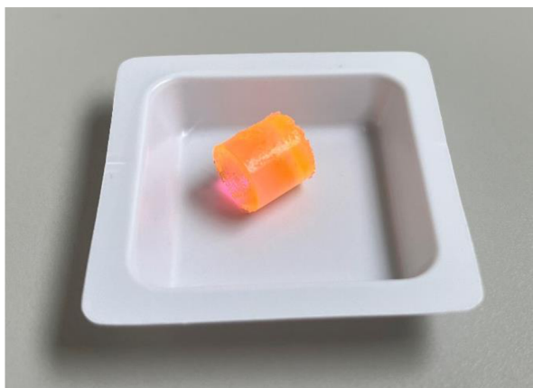
Obrázek 10: Vzorek PEGDA-thiol hydrogelu s inkorporovaným barvivem Rhodaminu 6G
