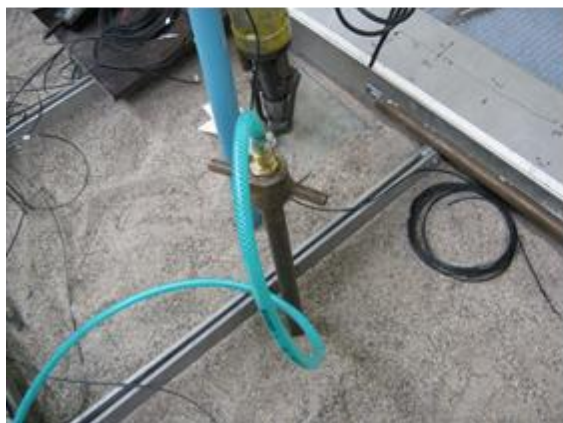
Obrázek 25: Průběh 1. Pilotní injektáže nZVI do 3-D systému
