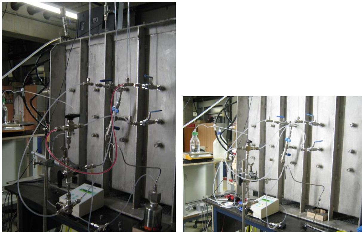
Obrázek 16: Aplikace kontaminantu PCE do experimentálního boxu
