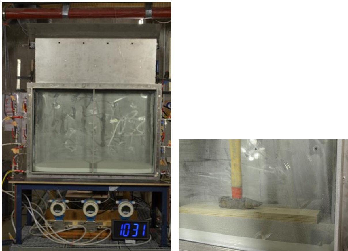
Obrázek 14: Příprava experimentu (vlevo - rovnoměrné naplňování 2-D boxu pomocí trychtýře se zabudovaným sítím; vpravo – zhutňování jednotlivých vrstev)
