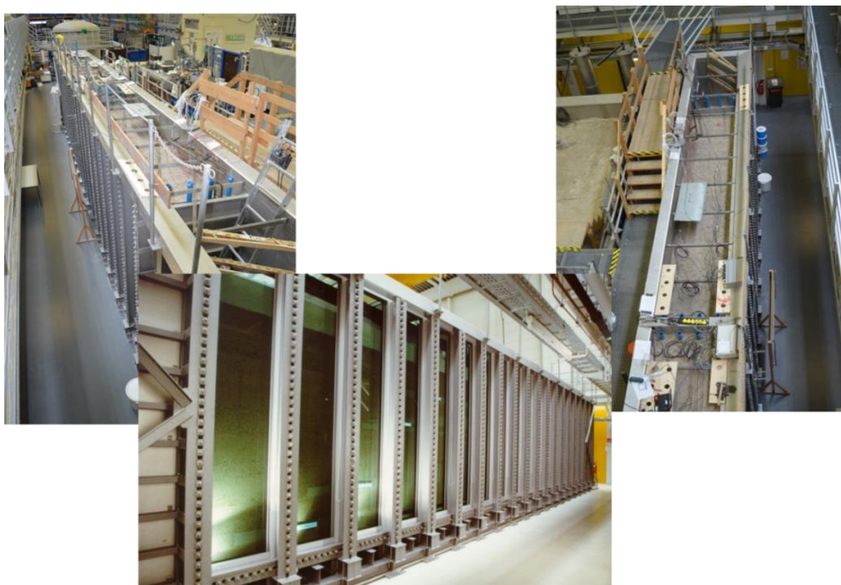
Obrázek 17: 3-D experimentální box ve výzkumném centru VEGAS (16 m x 1 m x 3 m (D x Š x V))
