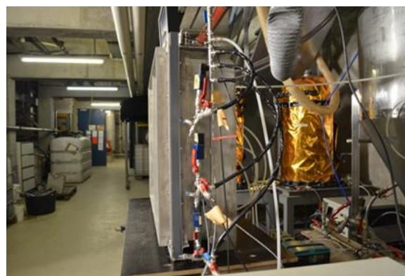
Příloha 2: Fotografie okrajových podmínek 2-D experimentu (dvou pevných potenciálů - konstantní hladina #1 a konstatní hladina 2; zvětšené schéma k náhledu viz Obrázek 11)
