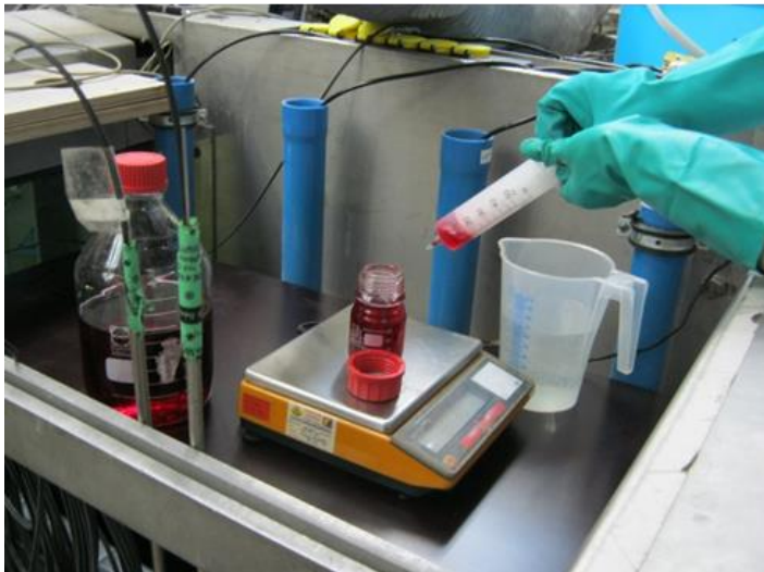
Obrázek 20: Aplikace PCE do porézního prostředí 3-D experimentu
