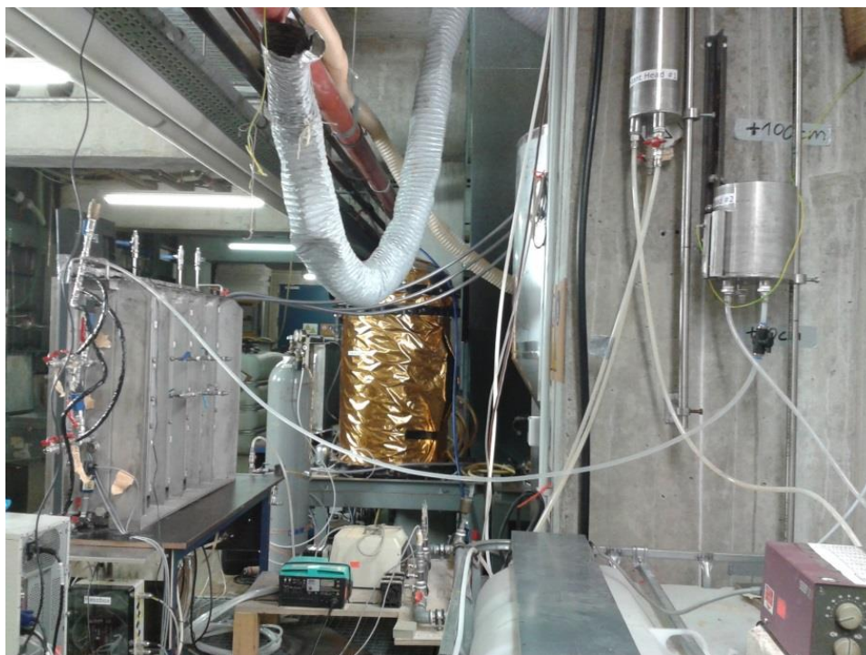
Obrázek 15: Nastavení polohy konstantní hladiny #1 a konstantní hladiny #2 před migračním experimentem
