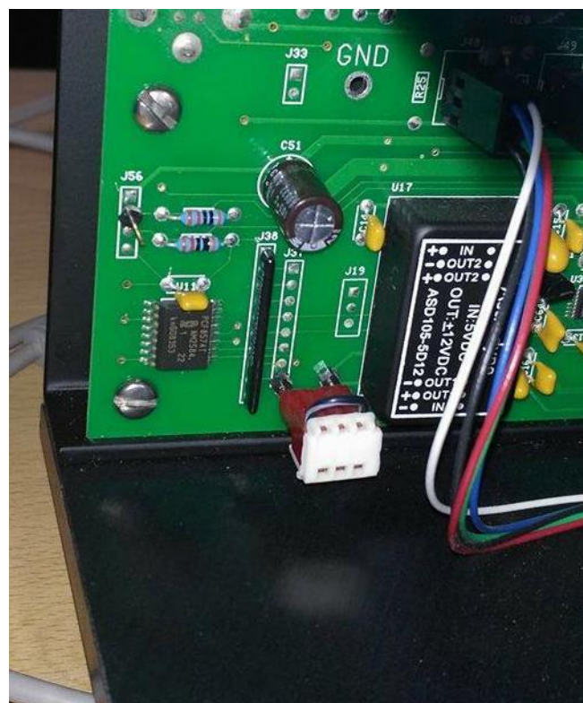
Obrázek 13: Upevnění jumperu na základní desce.
