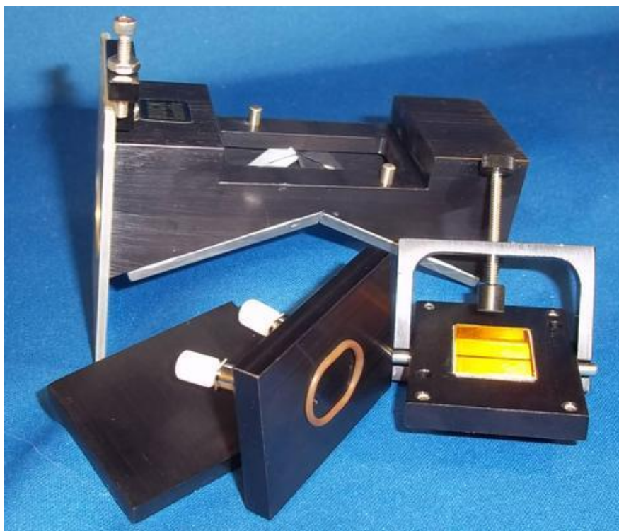
Obrázek 5: ATR hranol PLC-11M pro IR spektrofotometr Buck 500 [27].
