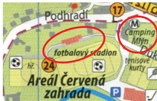
Obr. 4.11 – Neexistující muzeum, chybné vyjádření plošného prvku, výřez z plánu města Boskovice
