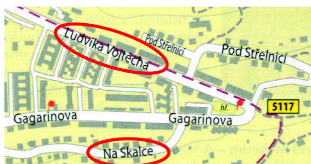
Obr. 4.6 – Příklad přesahujícího popisu, výřez z plánu města Boskovice 1 : 10 000, ARTRON s. r. o., 2015
