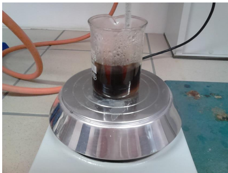
Obrázek 3: Roztok částic CoFe 2 O 4 připravený na základě poznatků z předešlých neúspěšných pokusů
