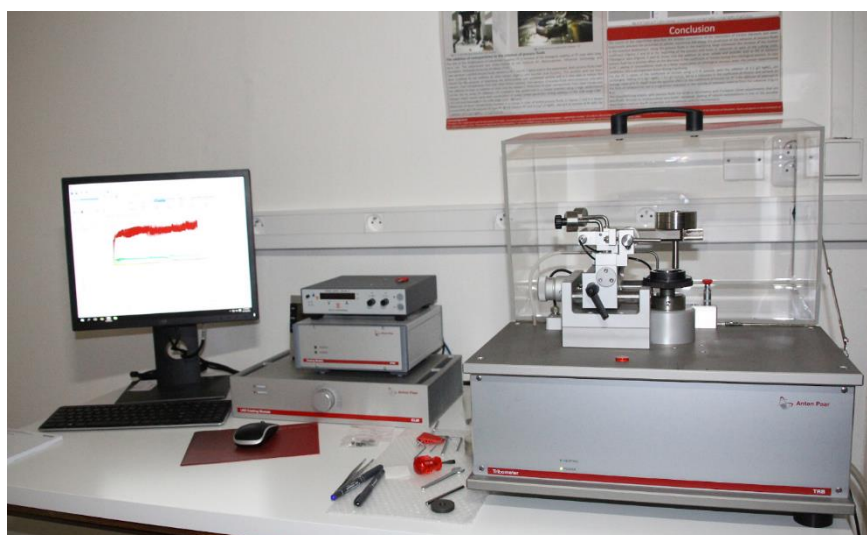
Obrázek 27 Tribometr Anton Paar TRB3 pro suché a kapalné prostředí
