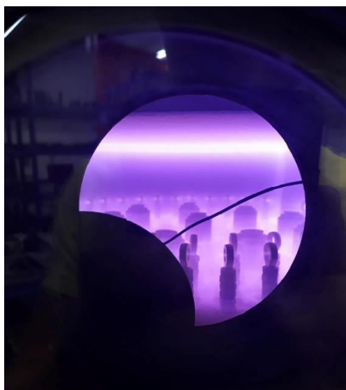
Obrázek 11 Iontová nitridace – anomální doutnavý výboj
