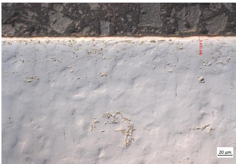
Obrázek 38 Změření sloučeninové vrstvy vzorku 14N (přibliženo 500x)
