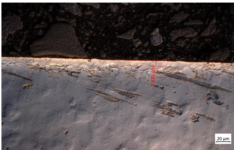
Obrázek 39 Změření sloučeninové vrstvy vzorku 14B (přibliženo 500x)
