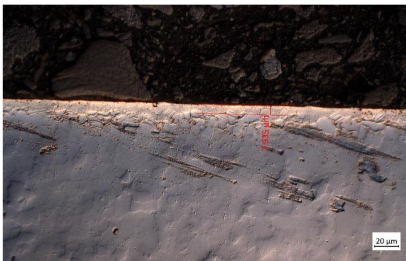
Obrázek 39 Změření sloučeninové vrstvy vzorku 14B (přibliženo 500x)
