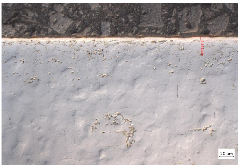
Obrázek 38 Změření sloučeninové vrstvy vzorku 14N (přibliženo 500x)
