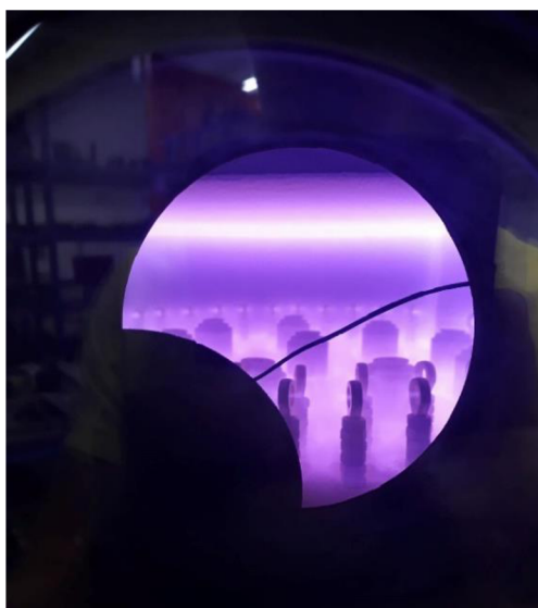
Obrázek 11 Iontová nitridace – anomální doutnavý výboj
