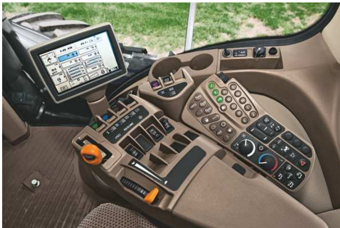
Obrázek 14 - Ovládací konzole CommandARM traktoru John Deere (zdroj dat: http://www.eurasia.kz/en/catalog/machinery/element.php )
