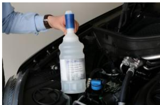
Obr. 42 Plnění AdBlue v motorovém prostoru [56]
