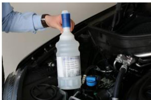
Obr. 42 Plnění AdBlue v motorovém prostoru [56]
