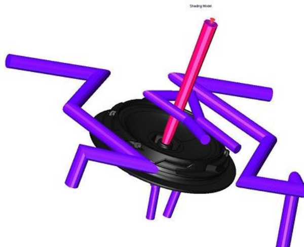
Obr. 21. Temperační systém víčka
