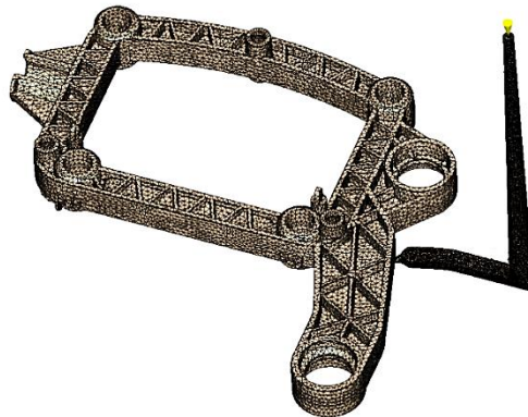
Obr. 29. Přesíťovaný model v Cadmould® 3D-F – rámeček
