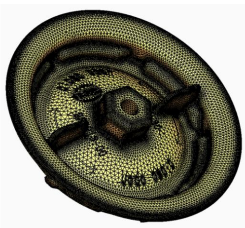
Obr. 28. Přesíťovaný model v Solidworks Plastics - víčko
