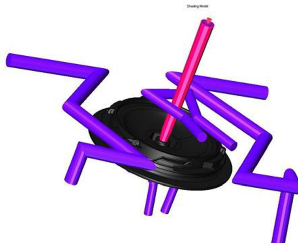
Obr. 21. Temperační systém víčka
