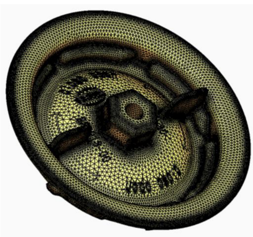
Obr. 28. Přesítovaný model v Solidworks Plastics - víčko
