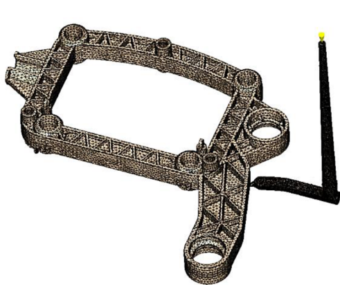
Obr. 29. Přesítovaný model v Cadmould® 3D-F – rámeček
