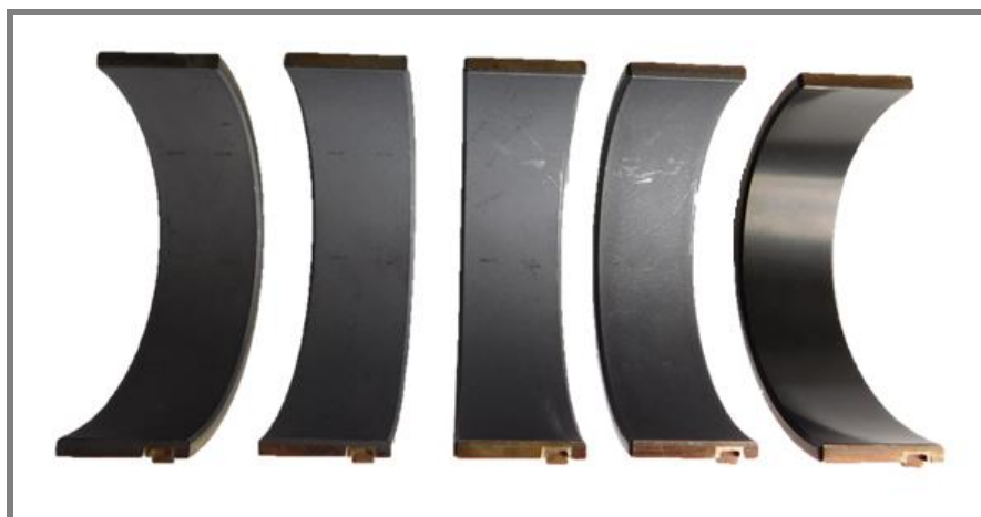
Obr. 5-31 Ložiska po provedení zkušebních nástřiků.
