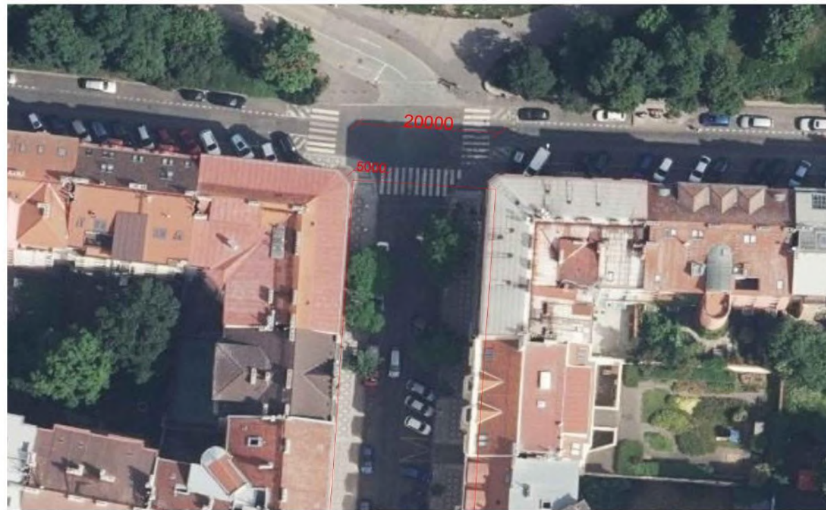
Obr. 105: Kóta šířky ulice, se značením šířky průjezdu, kdy minimální šířka pro průjezd složek záchranného systému činí 3,5 m
