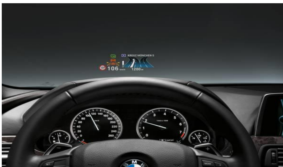
Obrázek 10 - HUD technologie u automobilů značky BMW
