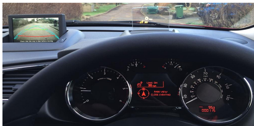
Obrázek 13 - HUD technologie u vozidla Peugeot 3008
