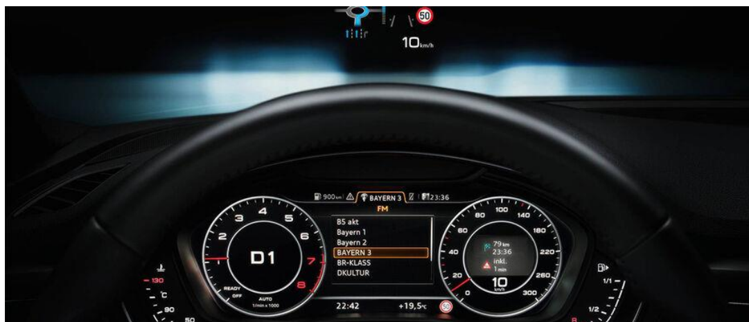
Obrázek 9 - HUD technologie v Audi A7
