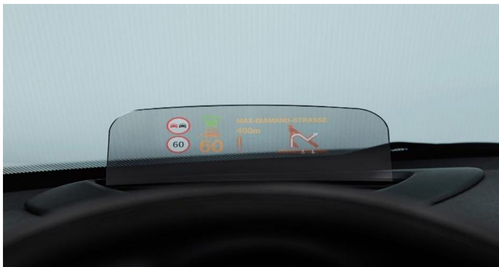
Obrázek 8 - Konstrukční řešení HUD technologie v osobním automobilu
