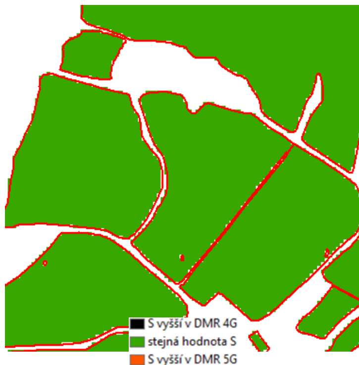
Obr. 36: Výřez srovnání S faktoru v DEM DMR 5G/DMR 4G v rozlišení 10 m (vlastní, 2016) Mapový podklad © Český úřad zeměměřický a katastrální, www.cuzk.cz
