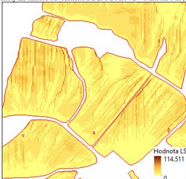
Obr. 40: Výřez území s hodnotami LS faktoru vypočteného z dat DMR 4G v rozlišení 5 m (vlastní, 2016) Mapový podklad © Český úřad zeměměřický a katastrální, www.cuzk.cz
