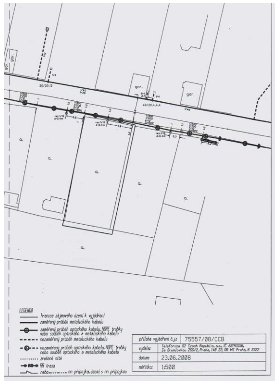
Obr. 8 Zaměřený a nezaměřený průběh optického a metalického kabelu 1 : 500
