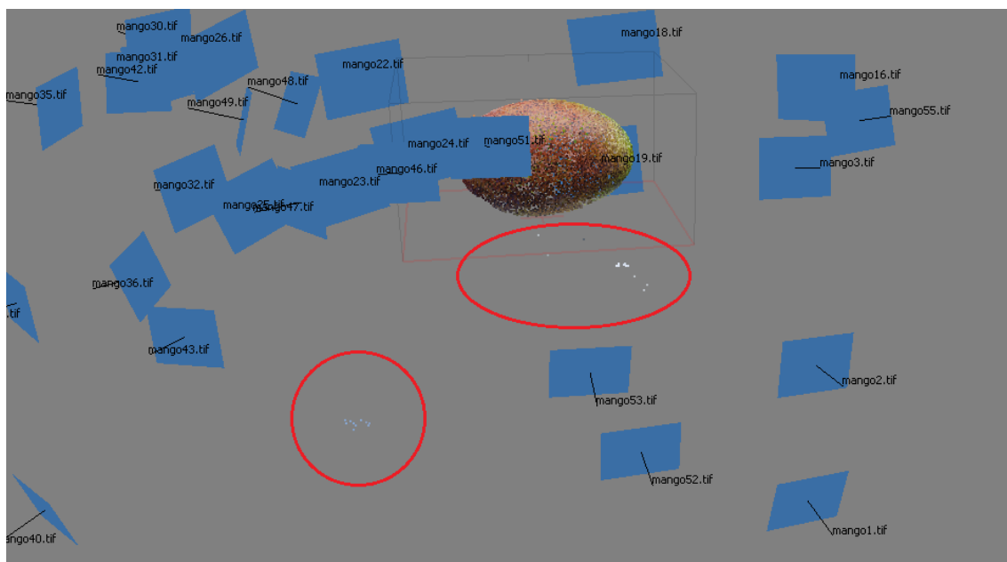
Obrázek 19 - PhotoScan: Tie points – defekt
