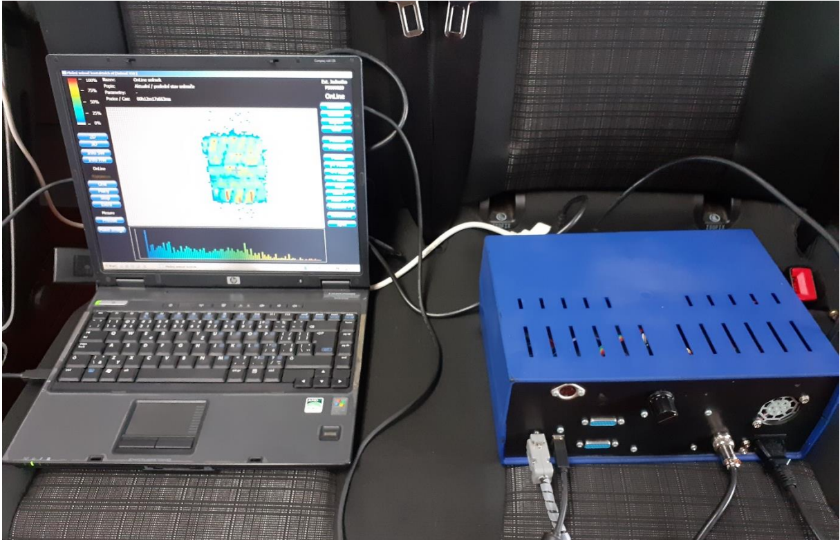
Obrázek 10: Měření rozložení kontaktních tlaků
