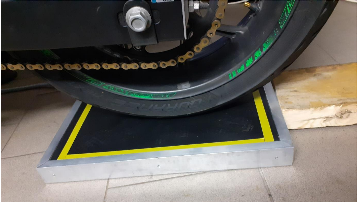
Obrázek 11: Měření rozložení kontaktních tlaků pod zadní pneumatikou motocyklu
