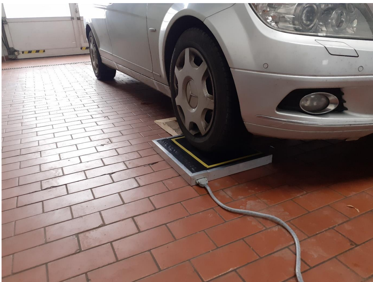
Obrázek 9: Měření rozložení kontaktních tlaků pneumatiky 205/55 R16
