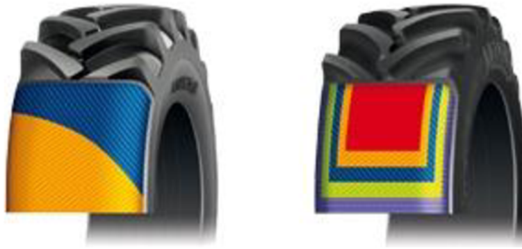
Obrázek 2: Diagonální kostra vlevo, Radiální vpravo (fialová barva, zbylé vyznačené části jsou jednotlivé vrstvy nárazníku)
