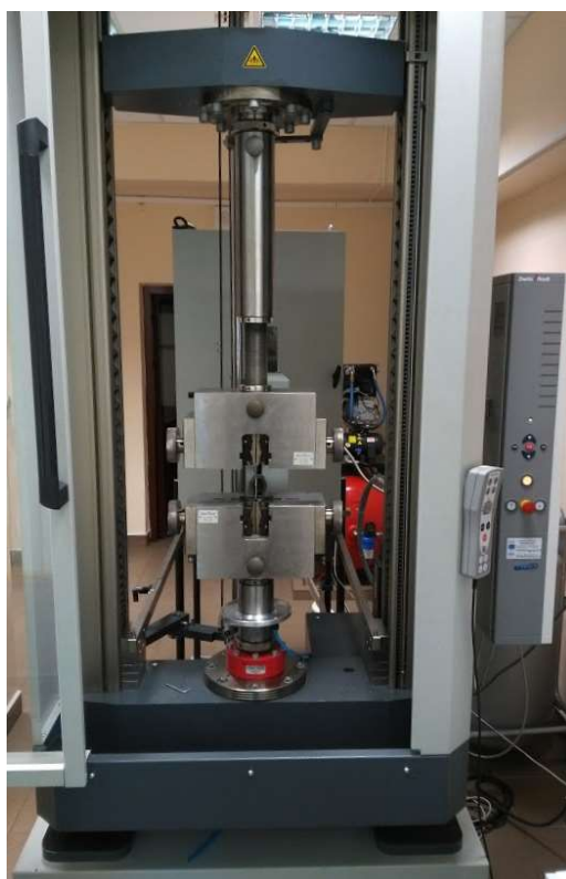
Obr. 22 Univerzální měřicí stroj pro zkoušky pevnosti ve smyku Zwick/Roell Z150
