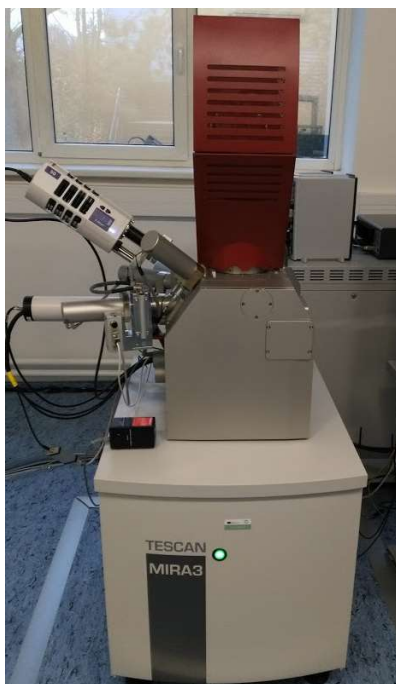
Obr. 28 Skenovací elektronový mikroskop TESCAN MIRA 3 GMX
