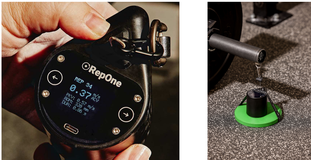
Obr. 3.1: Ukážka lineárneho prevodníku polohy RepOne Tether. Obrázky prevzaté z [38].
