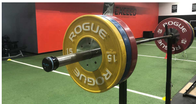
Obr. 3.3: Bezdrôtový senzor Flex, umiestnený na konci olympijskej tyče. Obrázok prevzatý z [49].
