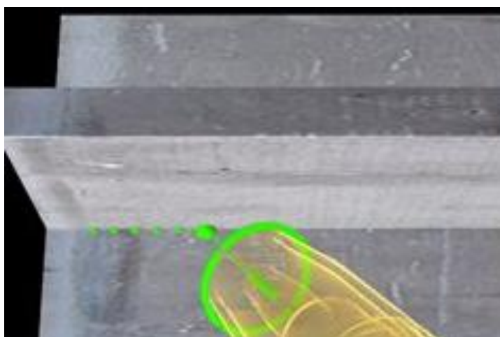
Obr. 20 Sklon hořáku, výlet drátu a rovnoměrný pohyb.
