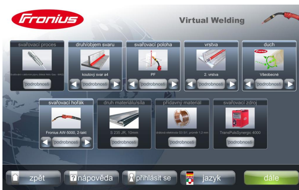
Obr. 27 Přehled svařovacích parametrů.
