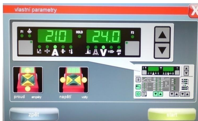
Obr. 37 Nastavení proudu a napětí před úkolem č. 5.
