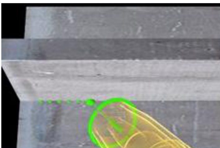
Obr. 20 Sklon hořáku, výlet drátu a rovnoměrný pohyb.
