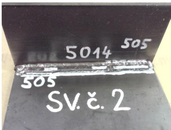
Obr. 89 Vzorek svářeče č. 2.
