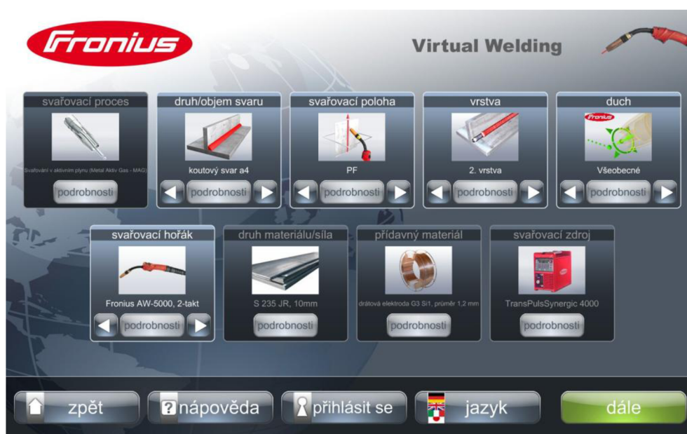
Obr. 27 Přehled svařovacích parametrů.
