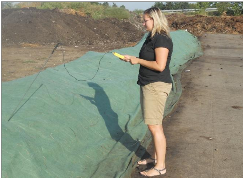
Měření teplot tyčovým teploměrem, srpen 2011
