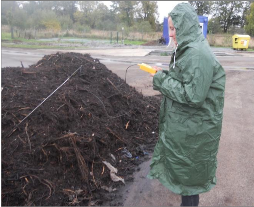
Měření teplot tyčovým teploměrem, srpen 2011
