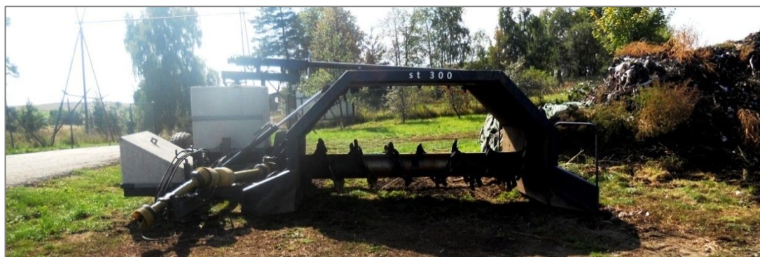
Foto č. 4: Traktorový překopávač kompostu (Doležalová 2010)
