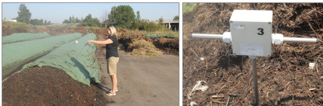
Foto č. 1: Měření teploty pomocí tyčového teploměru (vlevo) a teplotní sonda umístěná v zakládce (Doležalová 2011)
