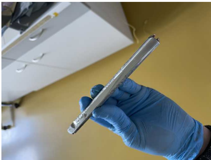
Obr. 2.19: Ingot po prvním broušení hrubým brusným papírem
