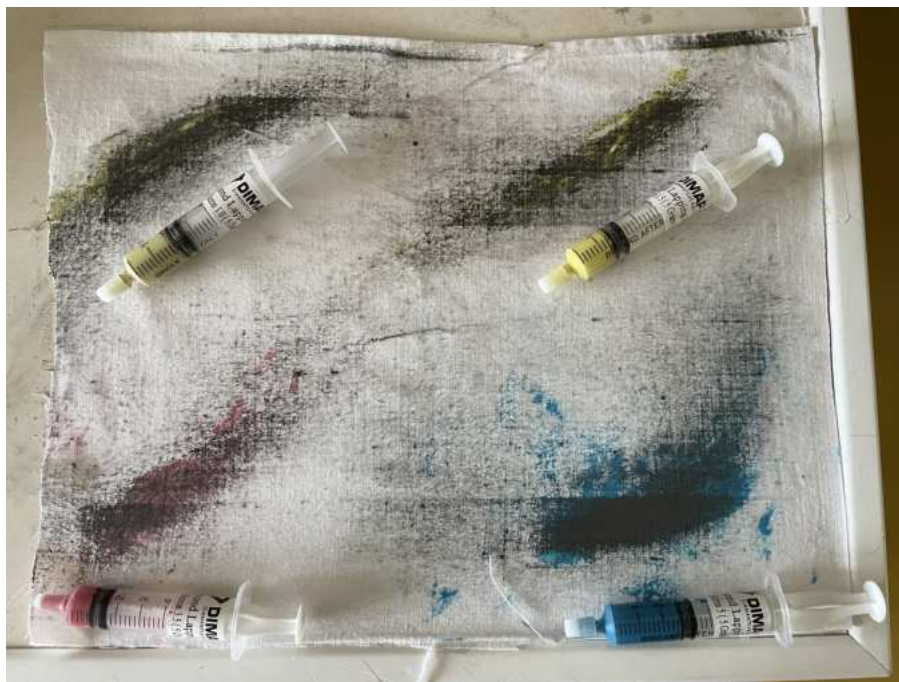
Obr. 2.22: Pracoviště při leštění diamantovými pastami
