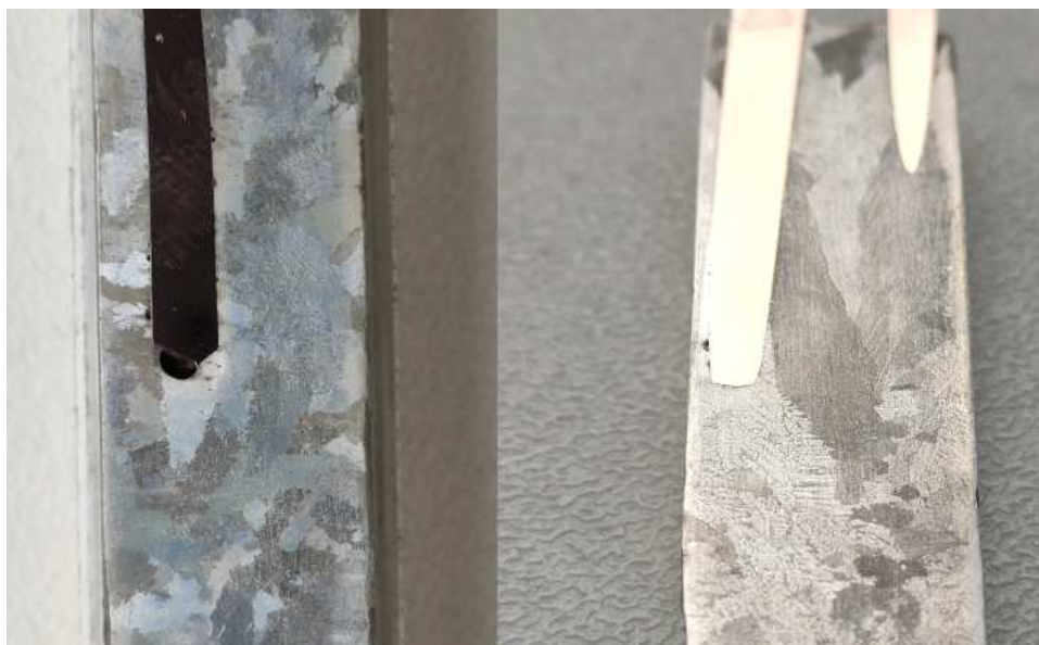
Obr. 2.34: Porovnání v oblasti proudových elektrod ingotu(1) bez průchodu proudu(vlevo) s ingotem(5) s průchodem proudu 25A(vpravo)
