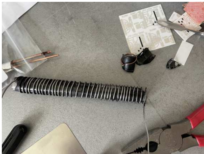
Obr. 2.2: Poškozená trubice po vytvoření třetího vzorku
