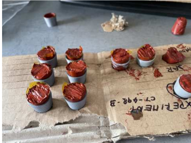
Obr. 2.6: Těsnící zátky ve formách
