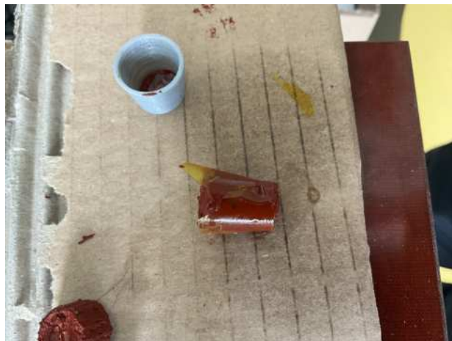
Obr. 2.7: Těsnící zátka s kaptonovou páskou
