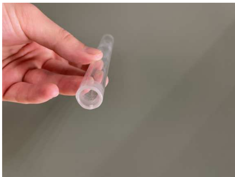
Obr. 2.3: Nová trubice po obroušení ostrých hran
