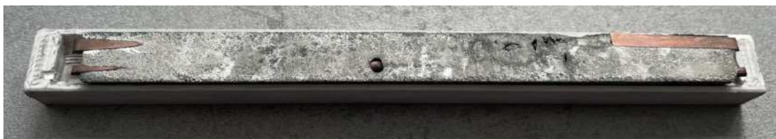
Obr. 3.4: 4. ingot bez průchodu proudu (zničeny leptáním)
