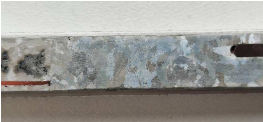
Obr. 2.30: Povrch ingotu bez průchodu proudu po leptání Ethanol + HNO 3 + HCl 40 vteřin
