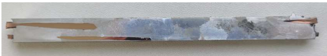
Obr. 3.3: 3. ingot s průchodem proudy 30A a po 5 min. 25A
