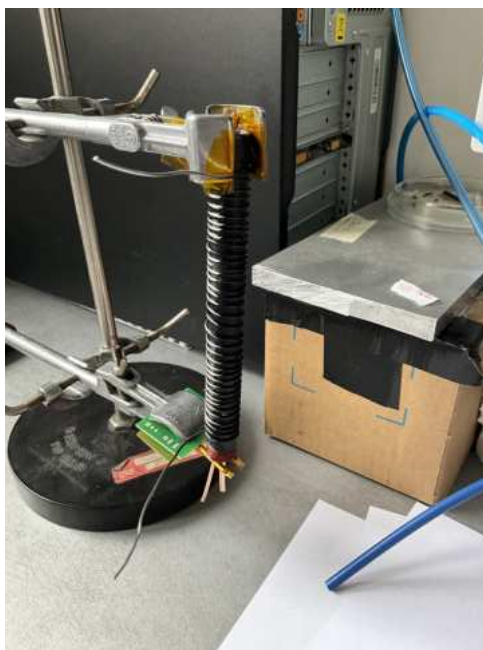
Obr. 2.1: Trubice v aparatuře s termoemisní barvou
