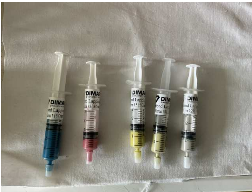
Obr. 2.21: Ukázka použitých diamantových past
