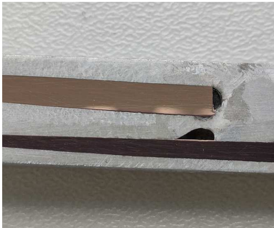
Obr. 2.35: Kladná elektroda(+I) ingotu(5) s průchodem proudu 25A
