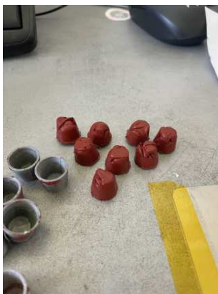
Obr. 2.5: Finální verze těsnících zátek
