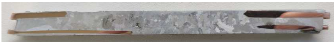
Obr. 3.2: 2. ingot s průchodem proudy 25A
