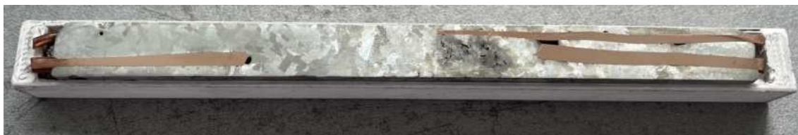
Obr. 3.1: 1. ingot bez průchodu proudy
