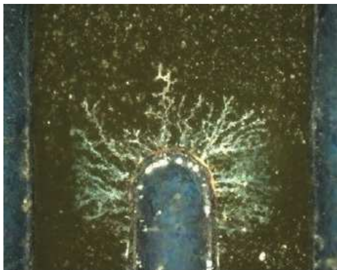
Obr. 1.13: Ukázka elektromigrace na pájeném spoji [18]
