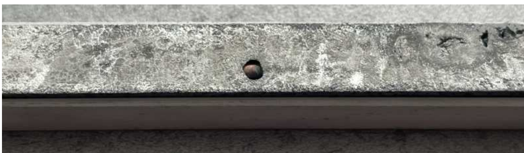
Obr. 2.31: Spálený ingot bez průchodu proudu leptadlem Ethanol + HNO 3 + HCl
