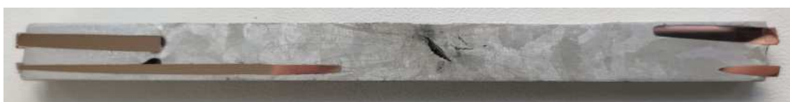
Obr. 3.5: 5. ingot s průchodem proudu 25A
