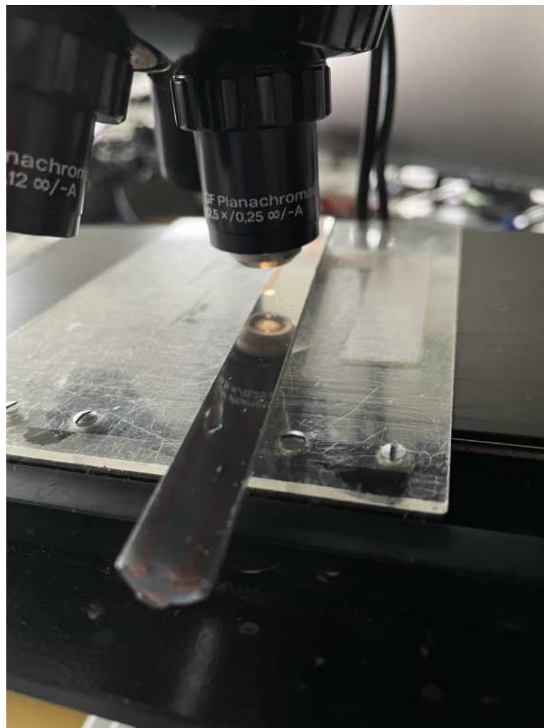
Obr. 2.23: Leštěný ingot všemi používanými pastami
