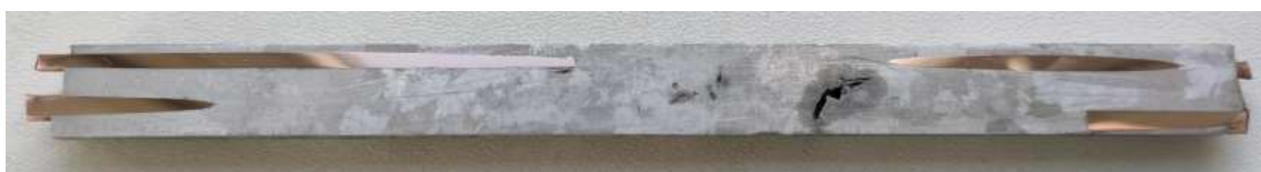
Obr. 3.6: 6. ingot s průchodem proudu 30A a po 5 min. 25A
