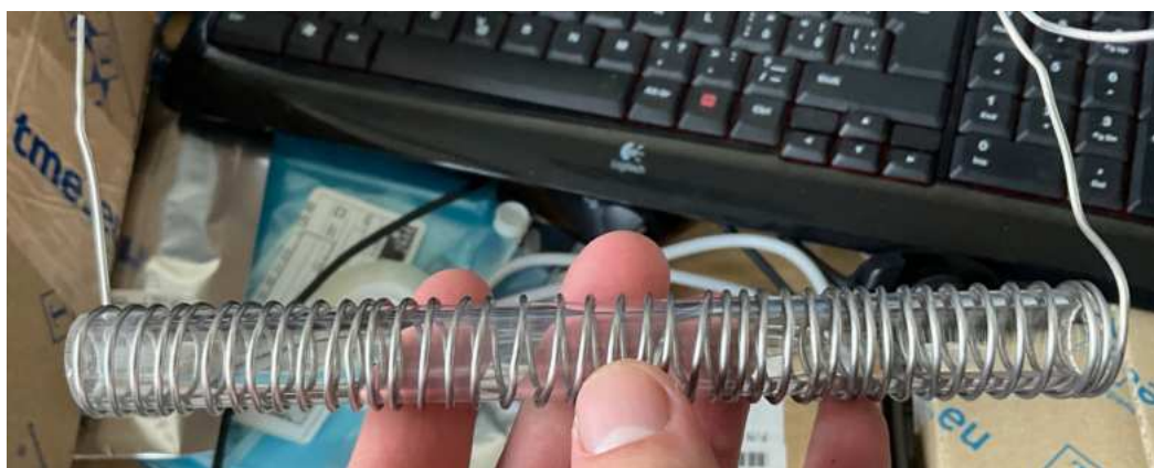
Obr. 2.4: Ukázka navinutého Kanthalu na trubici
