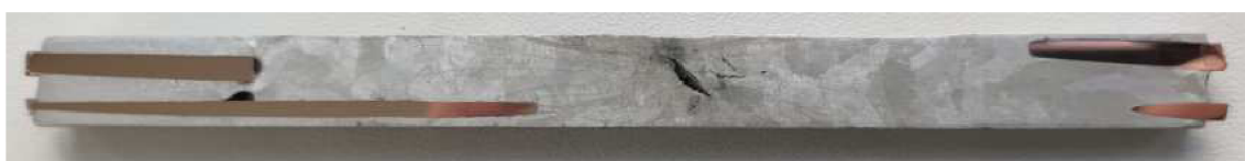
Obr. 3.5: 5. ingot s průchodem proudu 25A
