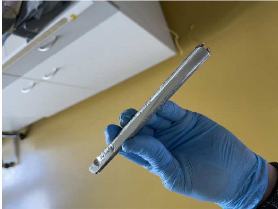
Obr. 2.19: Ingot po prvním broušení hrubým brusným papírem
