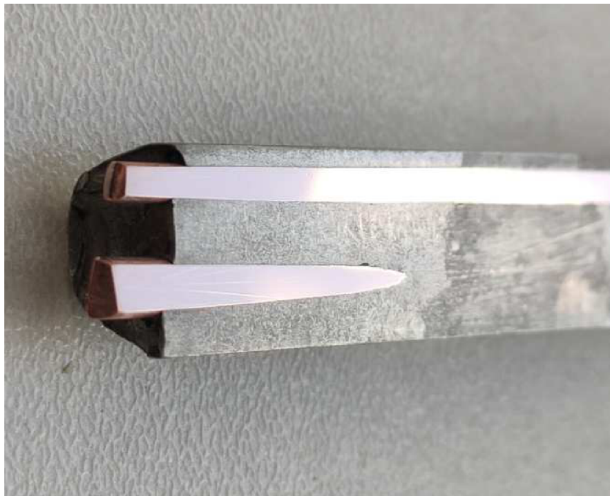
Obr. 2.38: Kladná proudová elektroda(+I) ingotu(6) s průchodem proudu 30A
