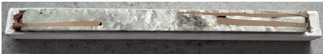
Obr. 3.1: 1. ingot bez průchodu proudu
