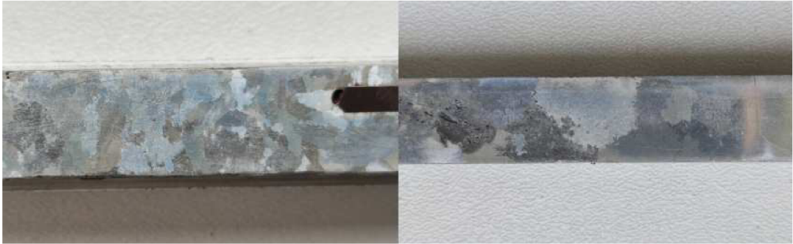
Obr. 2.37: Porovnání ingotu(1) bez průchodu proudu(vlevo) s ingotem(3) s průchodem proudu 30A(vpravo)
