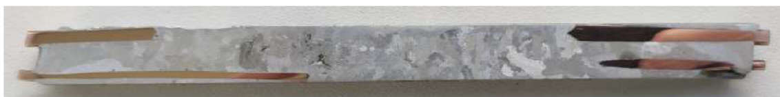
Obr. 3.2: 2. ingot s průchodem proudu 25A
