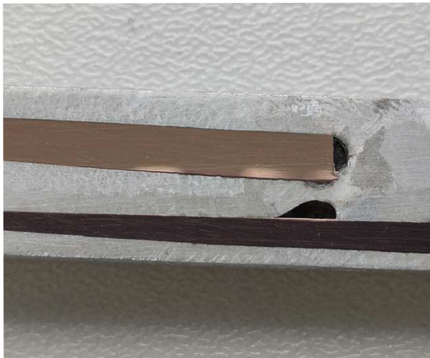
Obr. 2.35: Kladná elektroda(+I) ingotu(5) s průchodem proudem 25A
