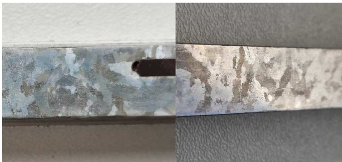
Obr. 2.33: Porovnání ingotu(1) bez průchodu proudu(vlevo) s ingotem(2) s průchodem proudu 25A(vpravo)
