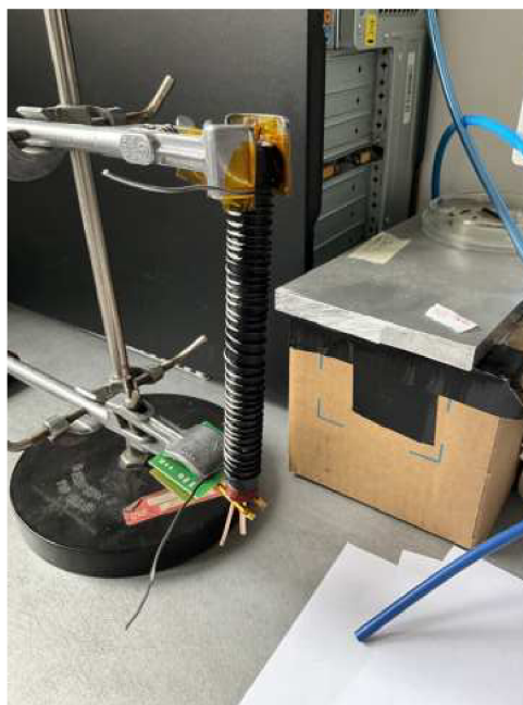
Obr. 2.1: Trubice v aparatuře s termoemisní barvou
