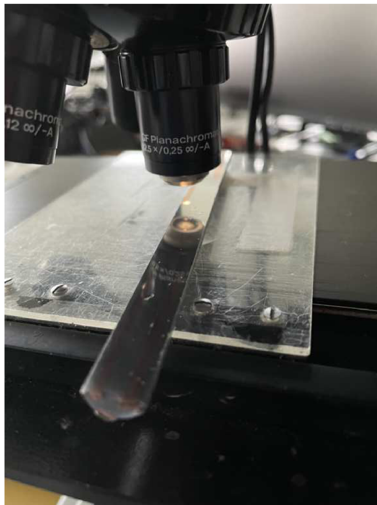
Obr. 2.23: Leštěný ingot všemi používanými pastami
