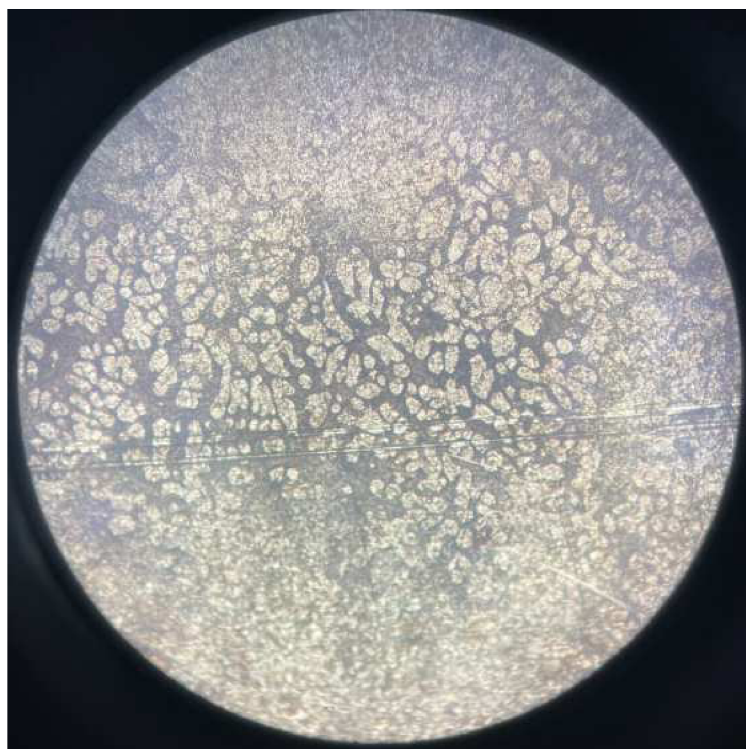
Obr. 2.28: Výsledek leptání ingotu bez průchodu proudy leptadlem Ethanol + HNO 3 + HCl
