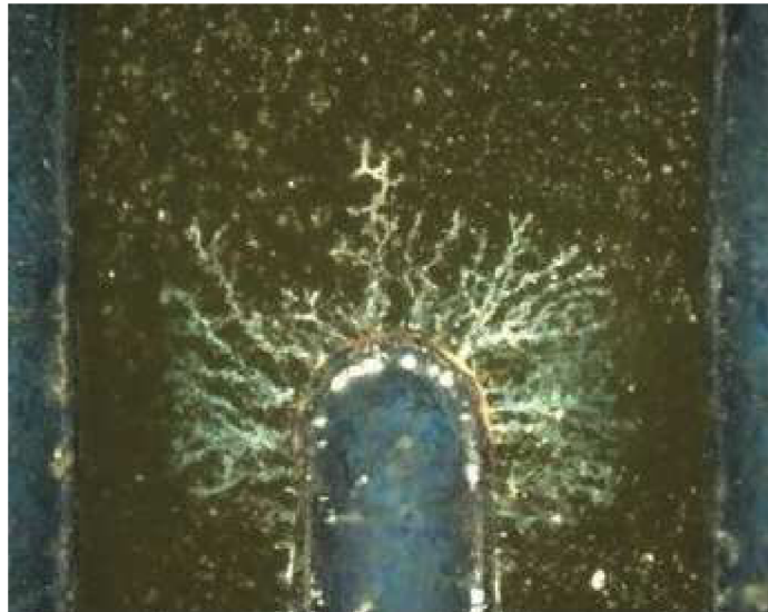
Obr. 1.13: Ukázka elektromigrace na pájeném spoji [18]
