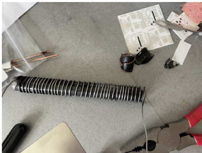
Obr. 2.2: Poškozená trubice po vytvoření třetího vzorku
