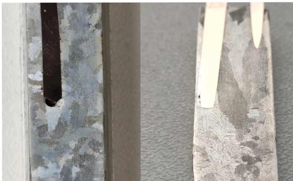
Obr. 2.34: Porovnání v oblasti proudových elektrod ingotu(1) bez průchodu proudem(vlevo) s ingotem(5) s průchodem proudem 25A(vpravo)
