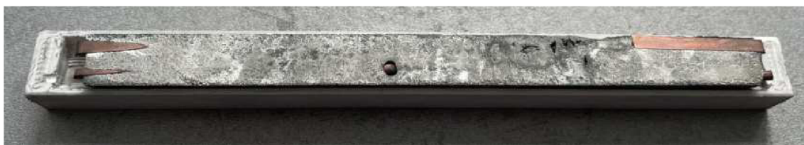
Obr. 3.4: 4. ingot bez průchodu proudu (zničeny leptáním)
