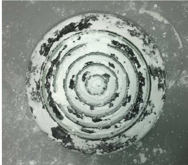
Obr. 37: Filtr po procesu přečerpávání pájecího prášku
