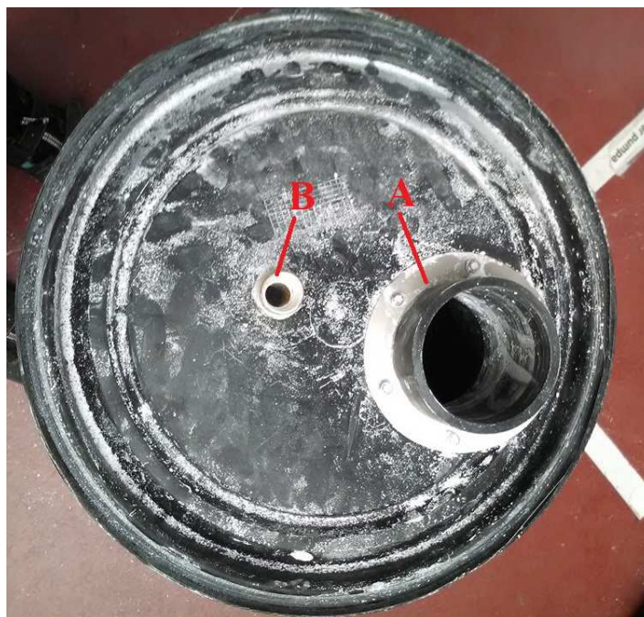
Obr. 39: Víko doplňované nádoby ze spodní strany (A-spojení vzduchového přívodu a víka doplňované nádoby, B-hadicový trn)
