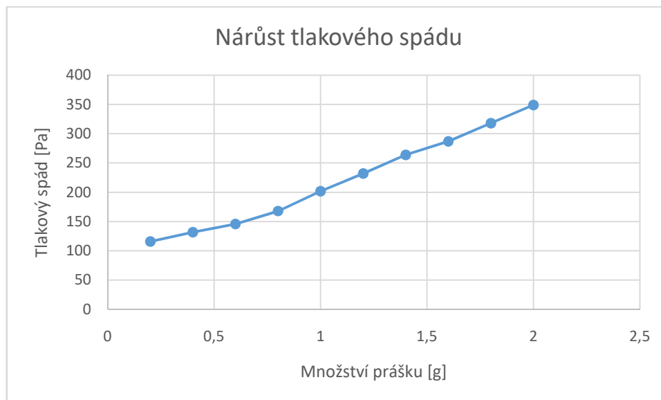
Graf 4: Graf nárůstu tlakového spádu v závislosti na množství zachyceného prášku
