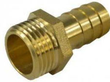
Obr. 32: Mosazný hadicový trn \frac{3}{4} " x 20 mm [Cerpadlobezstarosti, 2018]
