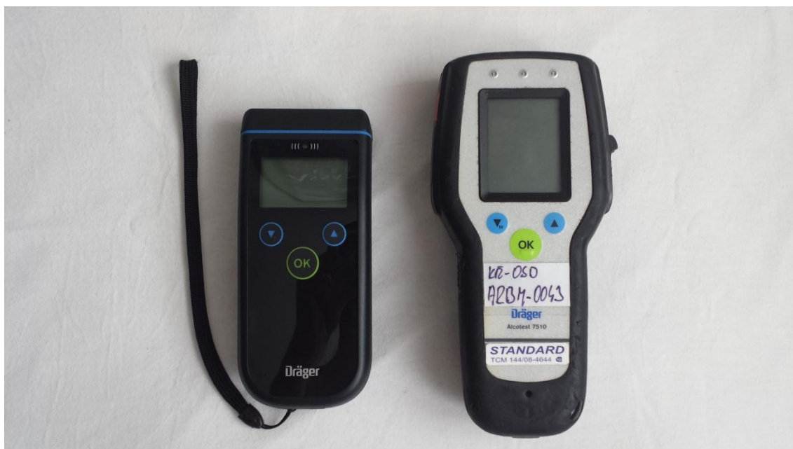
Obrázek 12: Analyzátory dechu použité při měření - Dräger Alcotest 6820 a Dräger Alcotest 7510 (vlastní zpracování).
