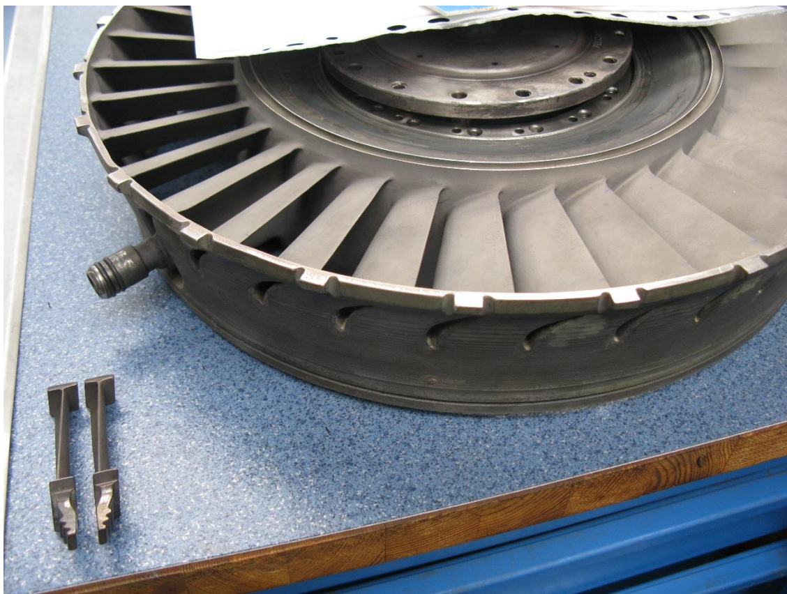
Obr. 15: Poslední stupeň turbíny (vyrobený přesným odléváním) před odesláním na mytí. V levém dolním rohu jsou lopatky turbíny se stromečkovým zámekem, který zaručuje jejich přesné ustavení.
