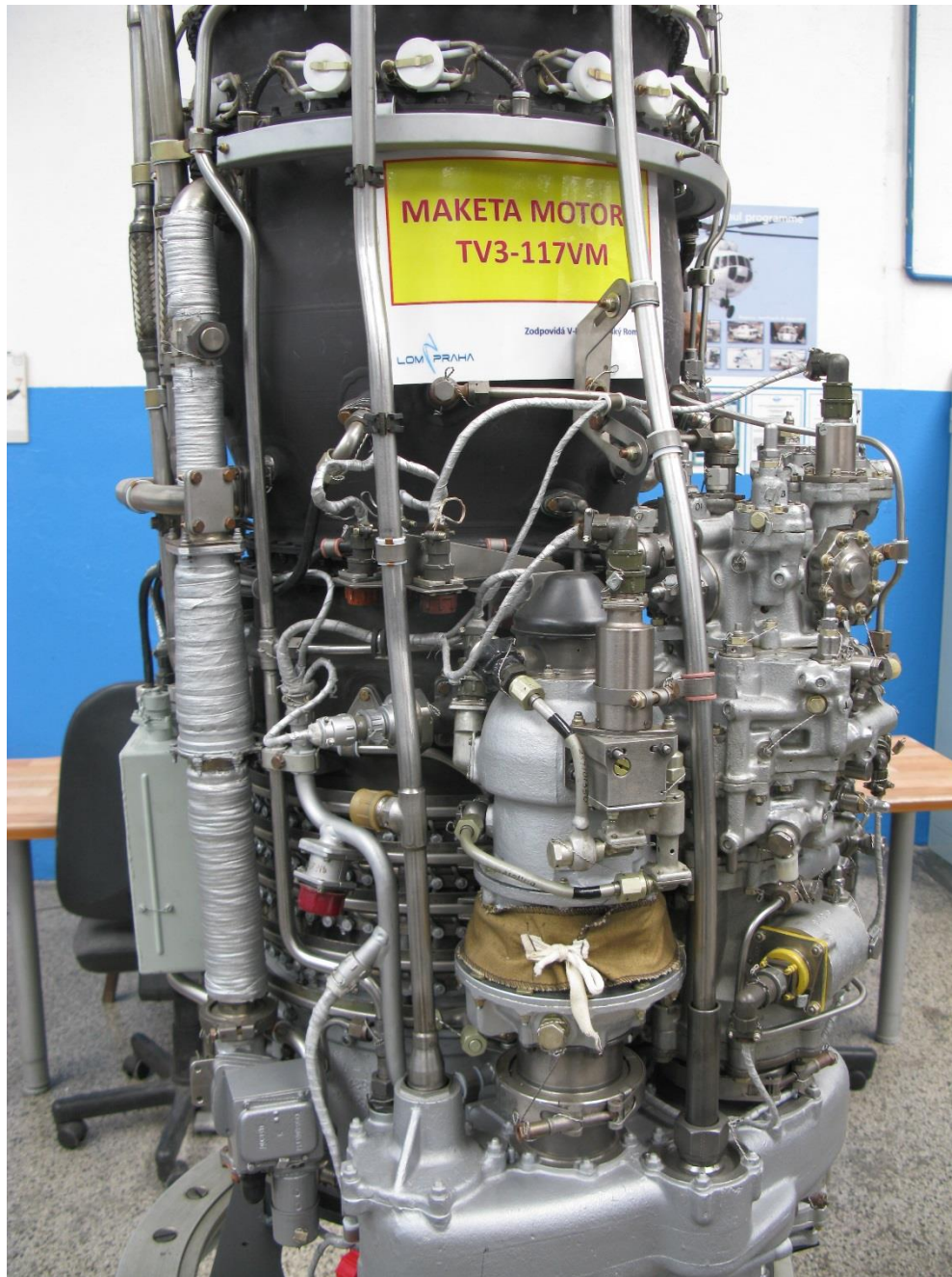
Obr. 19: Maketa motoru TV3, jednoho z nejrozšířenějších turbohřídelových motorů na světě, který se nachází například na vrtulnících Mi-17 či Mi-24, podle které montéři sestavují motory a kontrolují, zda je vše na správném místě.
