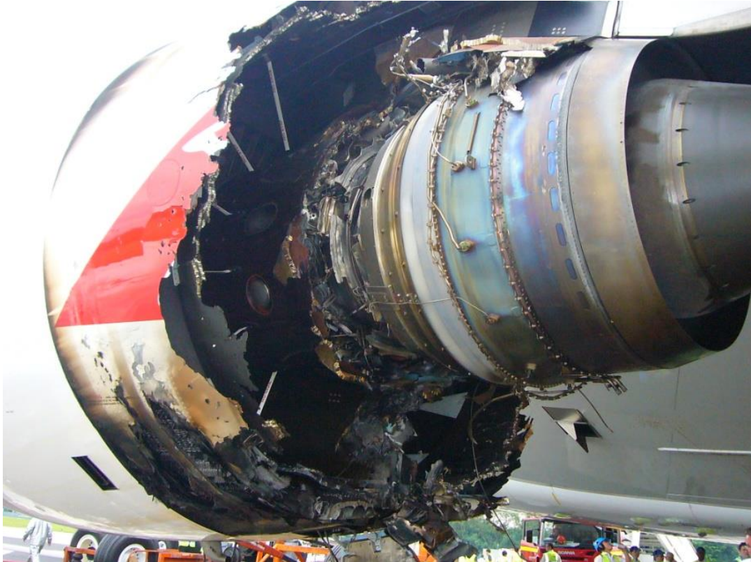
Obr. 9: Fotografie ukazuje rozsah poškození motoru Trent 900 letu Qantas 32 [8]
