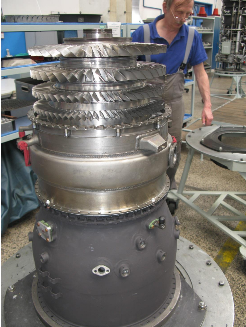
Obr. 17: Montáž kompresorové části motoru
