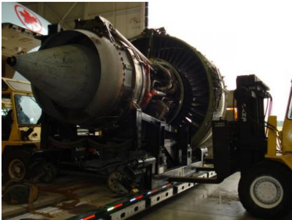
Obr. 13: Svěšení motoru General Electric GE 90 [17]
