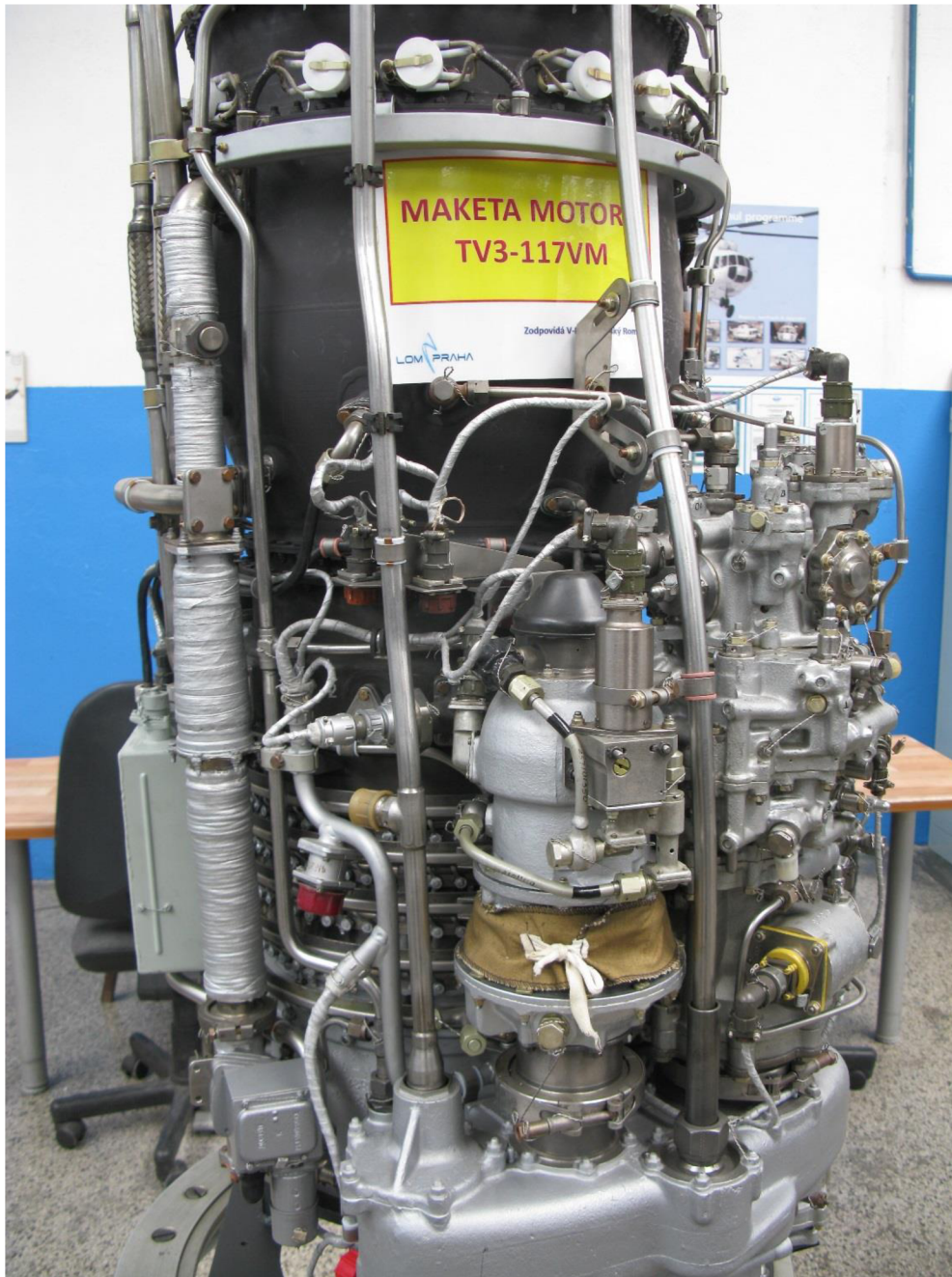
Obr. 19: Maketa motoru TV3, jednoho z nejrozšířenějších turbohřídelových motorů na světě, který se nachází například na vrtulnicích Mi-17 či Mi-24, podle které montéři sestavují motory a kontrolují, zda je vše na správném místě.
