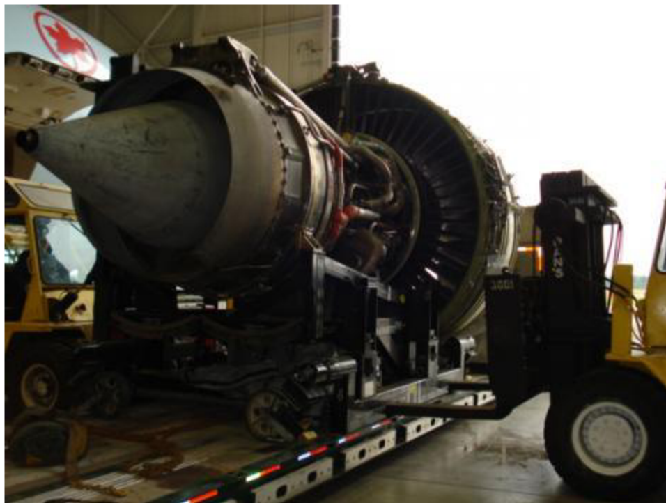
Obr. 13: Svěšení motoru General Electric GE 90 [17]
