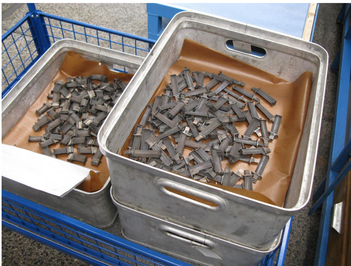
Obr. 14: Bedny s lopatkami turbíny, před čištěním. Jedna bedna lopatek má hodnotu něco kolem milionu českých korun.
