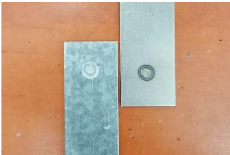
Obr. 26 Destrukce bodového svaru – vytvořený svar
