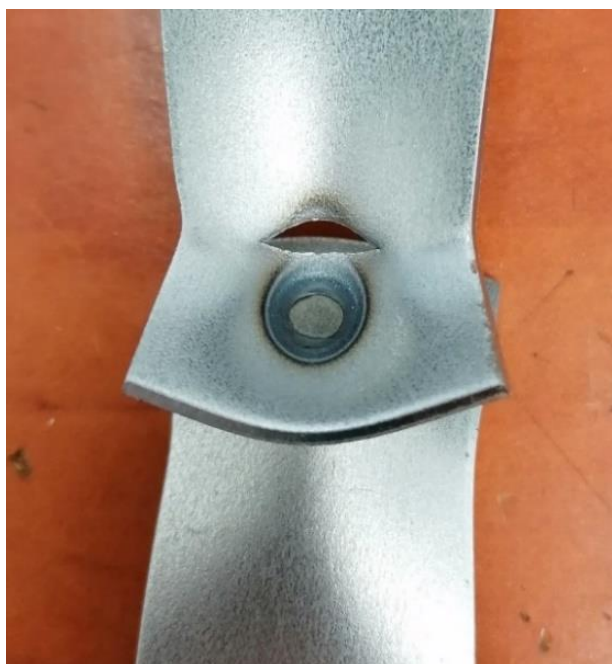
Obr. 27 Destrukce bodového svaru – svařovaný materiál
